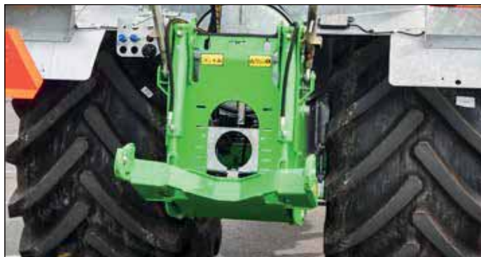
L600 hefinrichting op COBRA (bevestigd door 4 conische assen om een stevig geheel ervan te maken)
