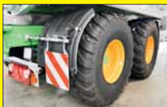
Spatbord op Vacu-CARGO met onafhankelijke spatlappen
