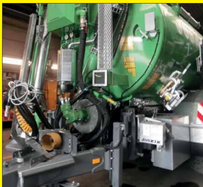
STORM met Power-Pack hydraulische aandrijving
