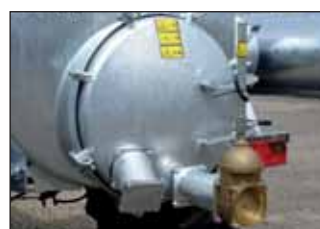
Mangat op scharnier (Ø 850 mm - op MODULO2 zonder schoorzuil)
