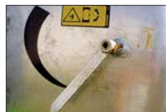
Vlotterpeilwijzer
