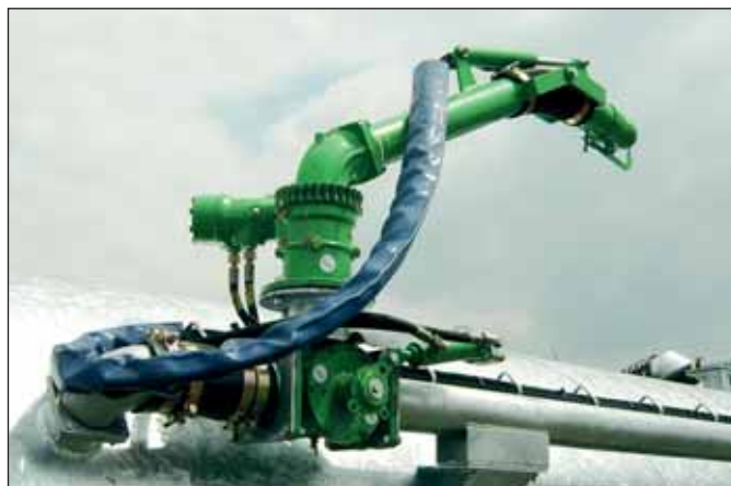
Volumetrisch mengen met retourleiding in de tank via hydraulische drijwegkraan
